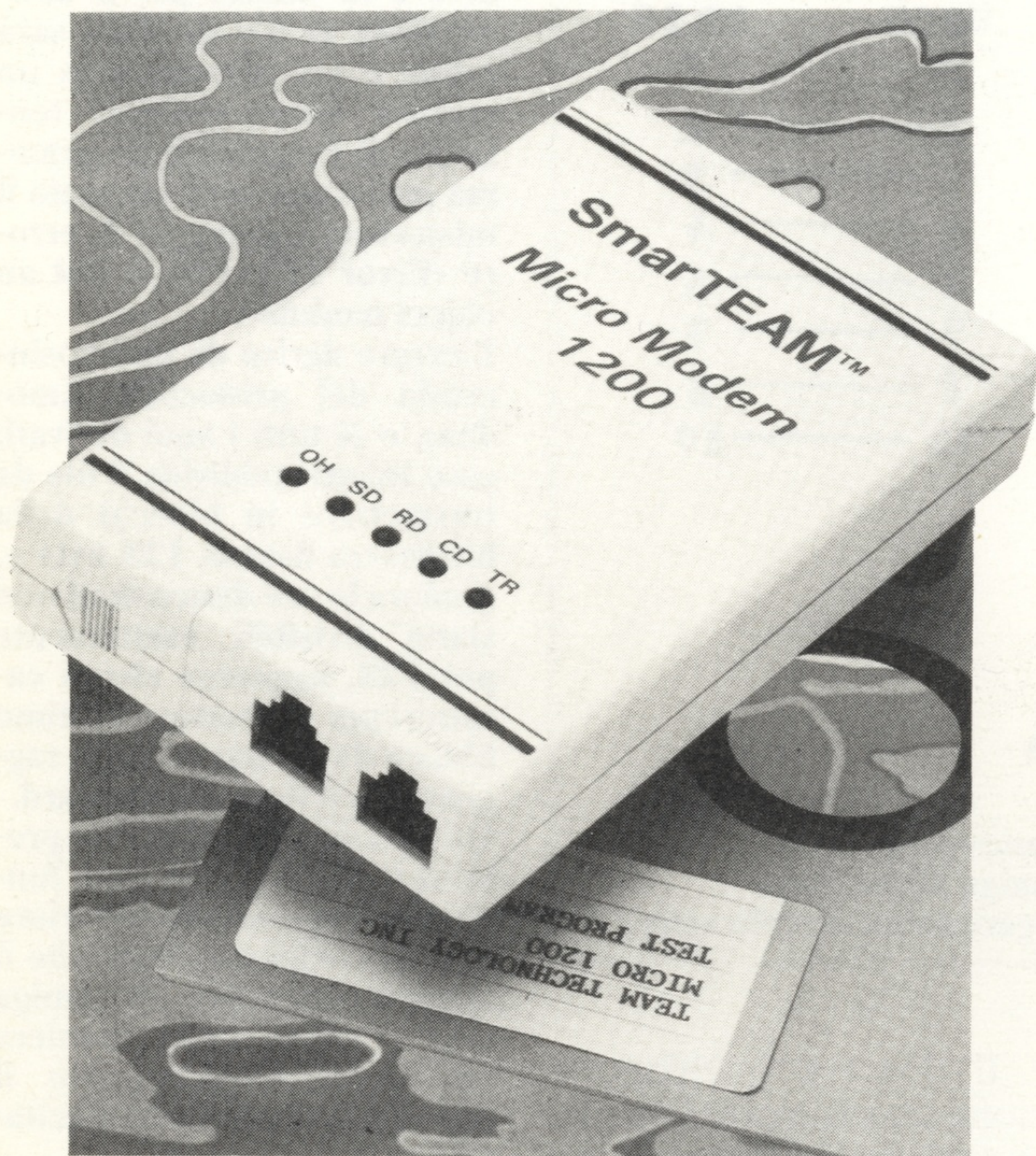
Lo SmarTeam MicroModem 1200 è un modem tascabile Hayes compatibile; arriva alla velocità di 1200 baud e viene alimentato dal computer stesso tramite la seriale.
